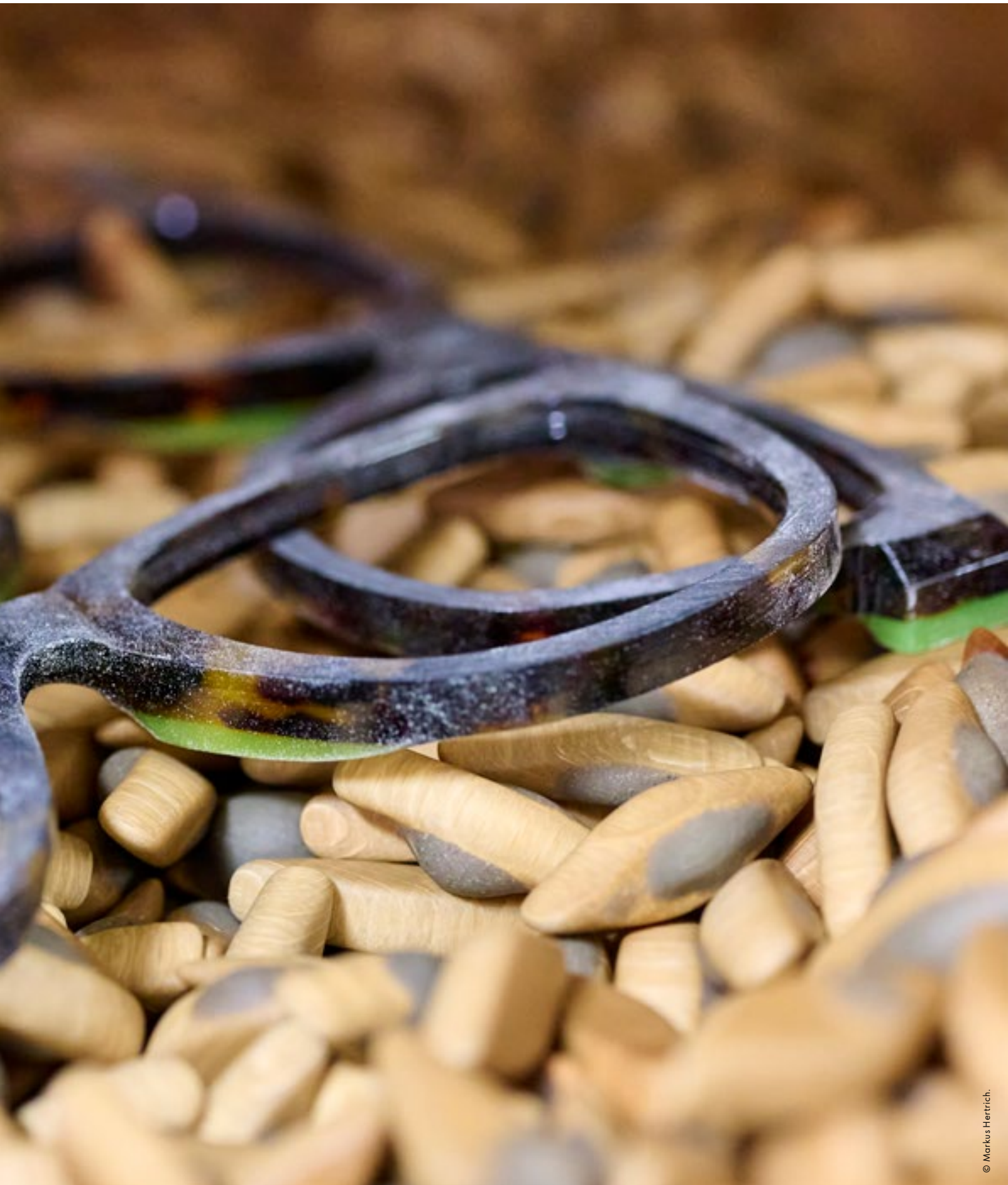
Eine Acetat-Fassung aus unserer nachhaltigen Kollektion elementra wird geschliffen, um die Kanten weicher zu machen
